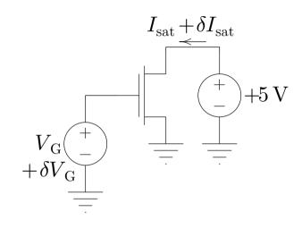
$$g_{\mathrm{m}} = \frac{\partial I_{\mathrm{sat}}}{\partial V_{\mathrm{G}}} = \frac{\kappa I_{\mathrm{sat}}}{U_{\mathrm{T}}}, I_{\mathrm{sat}} \ll SI_{\mathrm{s}}$$
